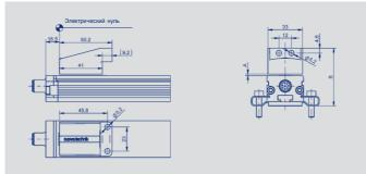
Маркер плавающего положения Z-TF1-P01 Раб.расстояние 0...4 мм Ном. расстояние 1,5 мм Крепление 49... 53 мм (размер В) Постоянное боковое смещение Материал PA6 GF30 Macca прибл. 40 г Номер по каталогу 400104343
