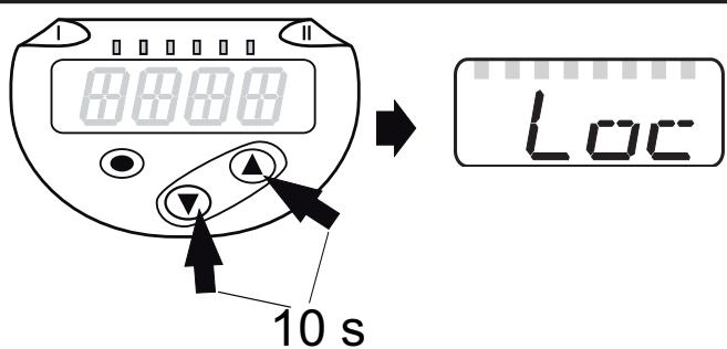
Во время эксплуатации: [Loc] кратко отображается при попытке внесения изменений в значения параметров.
