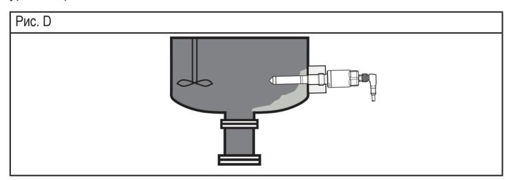
Рис. D: Поперечная установка, более глубокое положение в резервуаре (большое расстояние между наконечиком датчика и стенкой резервуара) обеспечивает подавление (осадков) отложений сильно клейких и вязких сред.
