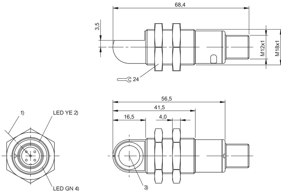
1) Направление отхода 90° штекер 2) Функция выхода 3) Ось ультразвукового преобразователя 4) Напряжение питания
