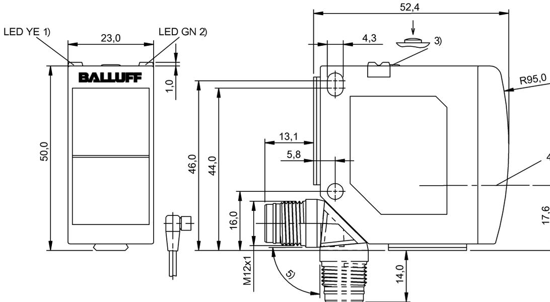
1) Активен режим выравнивания 2) Напр. питания / акт. режим выравн. 3) Режим выравнивания ВКЛ/ВЫКЛ 4) Оптическая ось 5) Поворачивается на 270°
