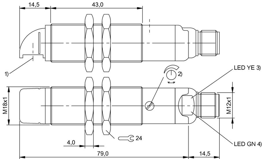
1) Оптическая ось 2) Sn 3) Функция выхода 4) Напряжение питания
