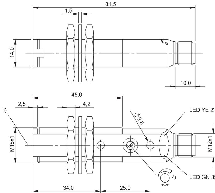
1) Оптическая ось 2) Функция выхода 3) Стабильность 4) Sn
