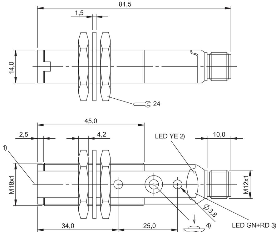
1) Оптическая ось 2) Функция выхода 3) Стабильность / сбой 4) Sn
