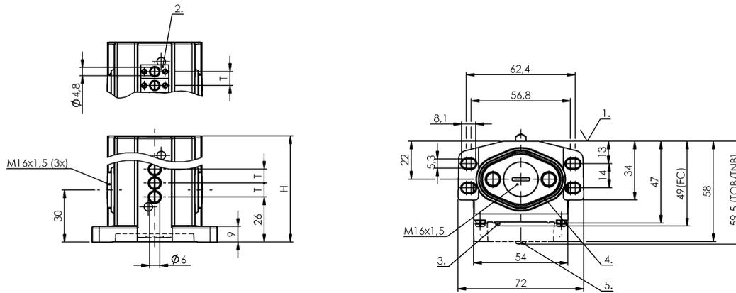
1) Опорная кромка 2) Противокристаллизационный толкатель 3) Функциональный индикатор FC 4) Уплотнительное кольцо 5) Функциональный индикатор FD/FE/LL
