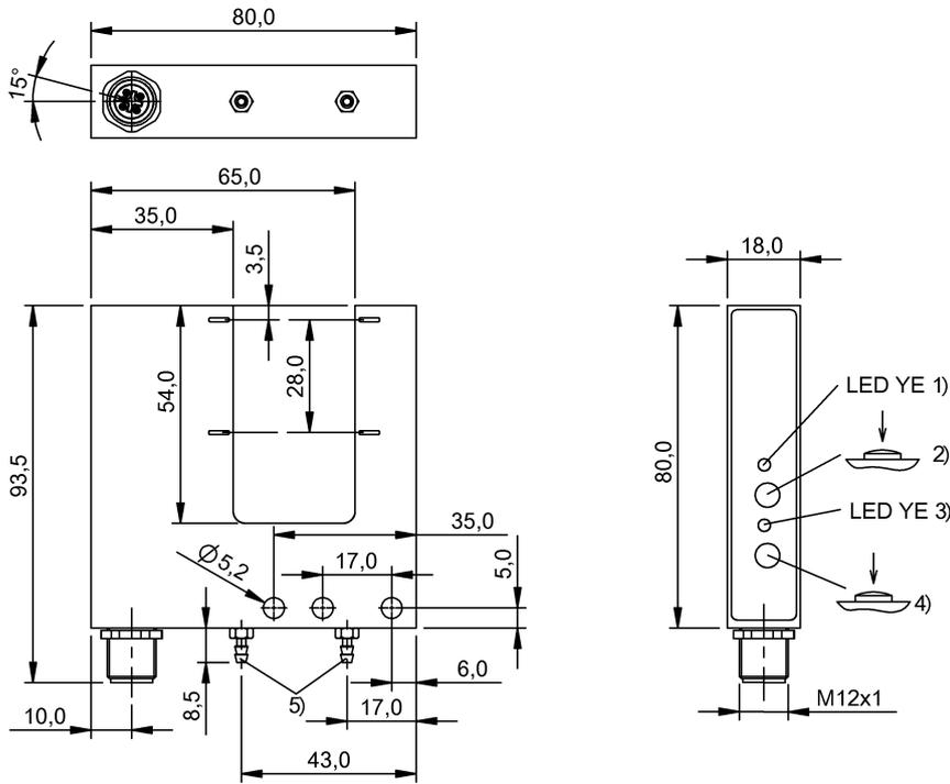
1) Q1 активен / сбой 2) Q1: чувств., светло/темно 3) Q2 активен / сбой 4) Q2: чувств., светло/темно 5) Пневматический разъем PK-3
