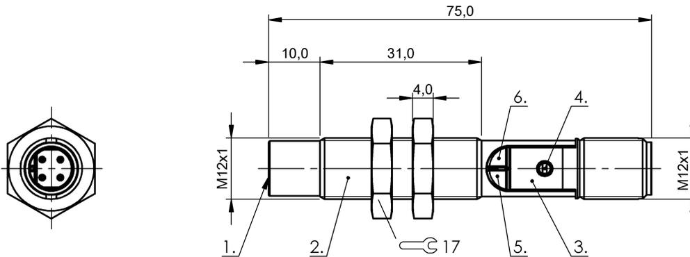
1) Активная поверхность 2) Корпус 3) Крышка 4) Потенциометр 5) СД напряжения питания 6) Функциональный СД
